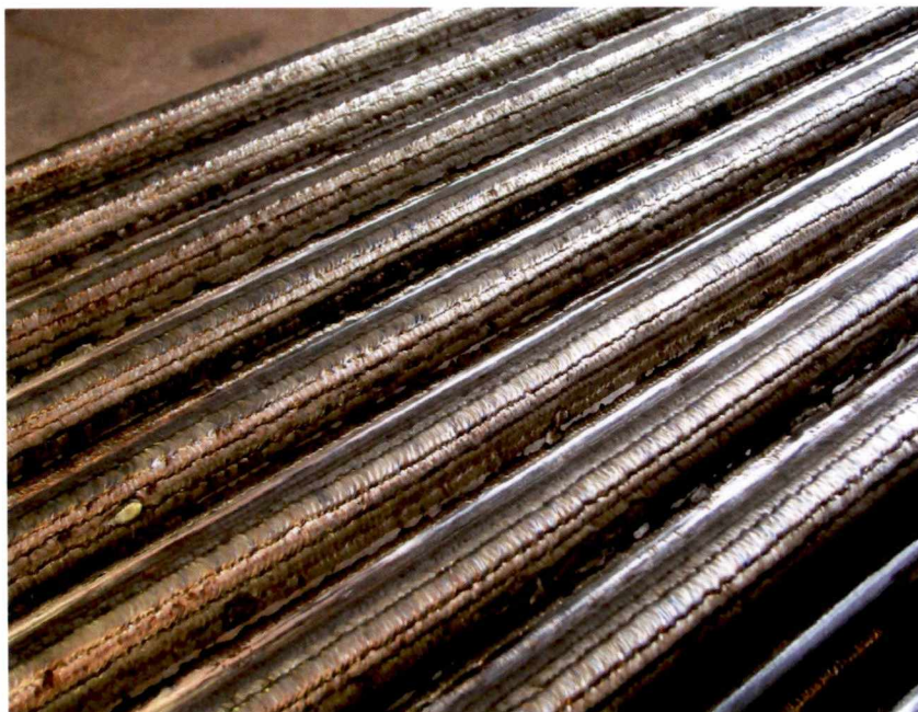
Foto nr 1. Inconel 625 påsvejst panel. Påsvejsningen er sket maskinelt i 2 lag. Efter påsvejsning er panelet rettet i en valse, som kun træder på finnerne.
