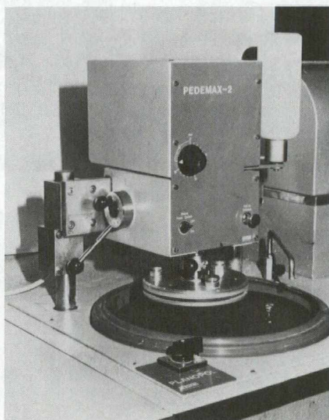
Fig. 3. Struers Planopol/Pedemax-3 slibe- og polermaskine anvendt til mikroslidmåling.
