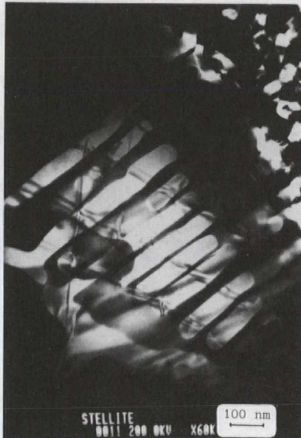
Fig. 5. Transmissionsmikroskopoptagelse af karbidnetværk i eutektiket i laserpåsvejst Stellite 6B.
