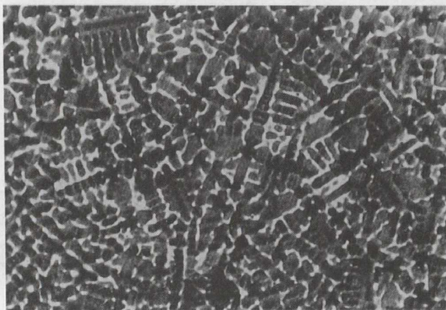
Figur 11. Mikrostruktur som støbt. (140 x) (Kallings reagens)
