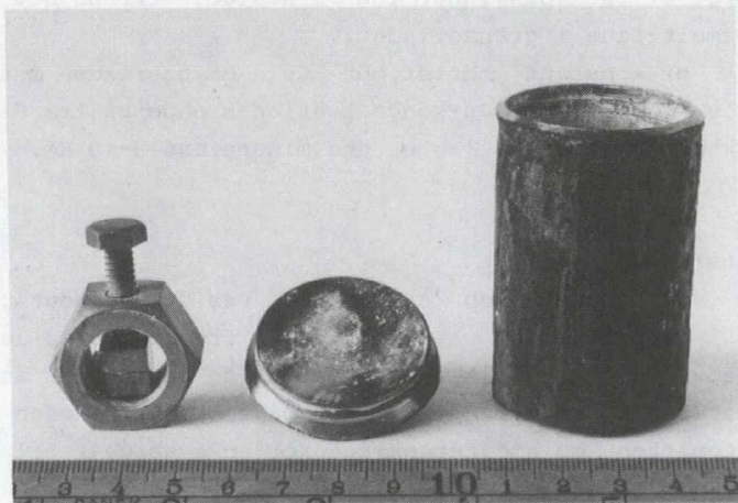
Figur 2. Sammenspændt diffusionspar med åbnet stålbeholder efter diffusionsglødning.
