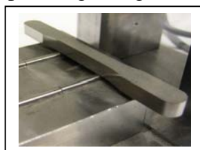
Fig. 2a - Emnet hviler på testfikstur
