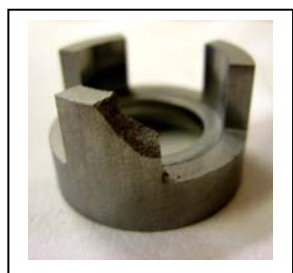
Fig. 1b - Grønemne med kantskade
