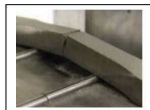
Fig. 2b - Emnet er knækket, og kraften registreret
