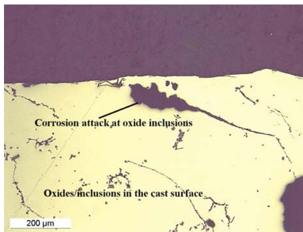
Illustration 17. Korrosion ved indeslutninger i overfladen på sandstøbt austenitisk 1.4584
